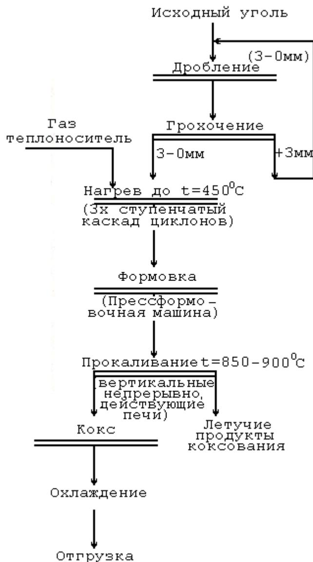
Рис.3.4. Принципиальная технологическая схема производства формованного кокса.
